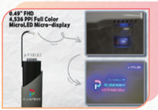
銓創顯示科技(股)公司- 元宇宙 0.49吋4536ppi超高像素 全彩µ-PixeLED Micro LED 顯示器
