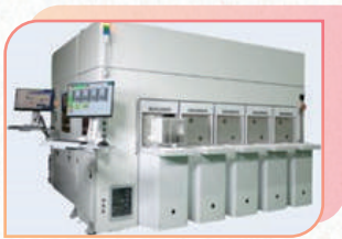
均豪精密工業(股)公司- 晶圓自動光學檢查設備
